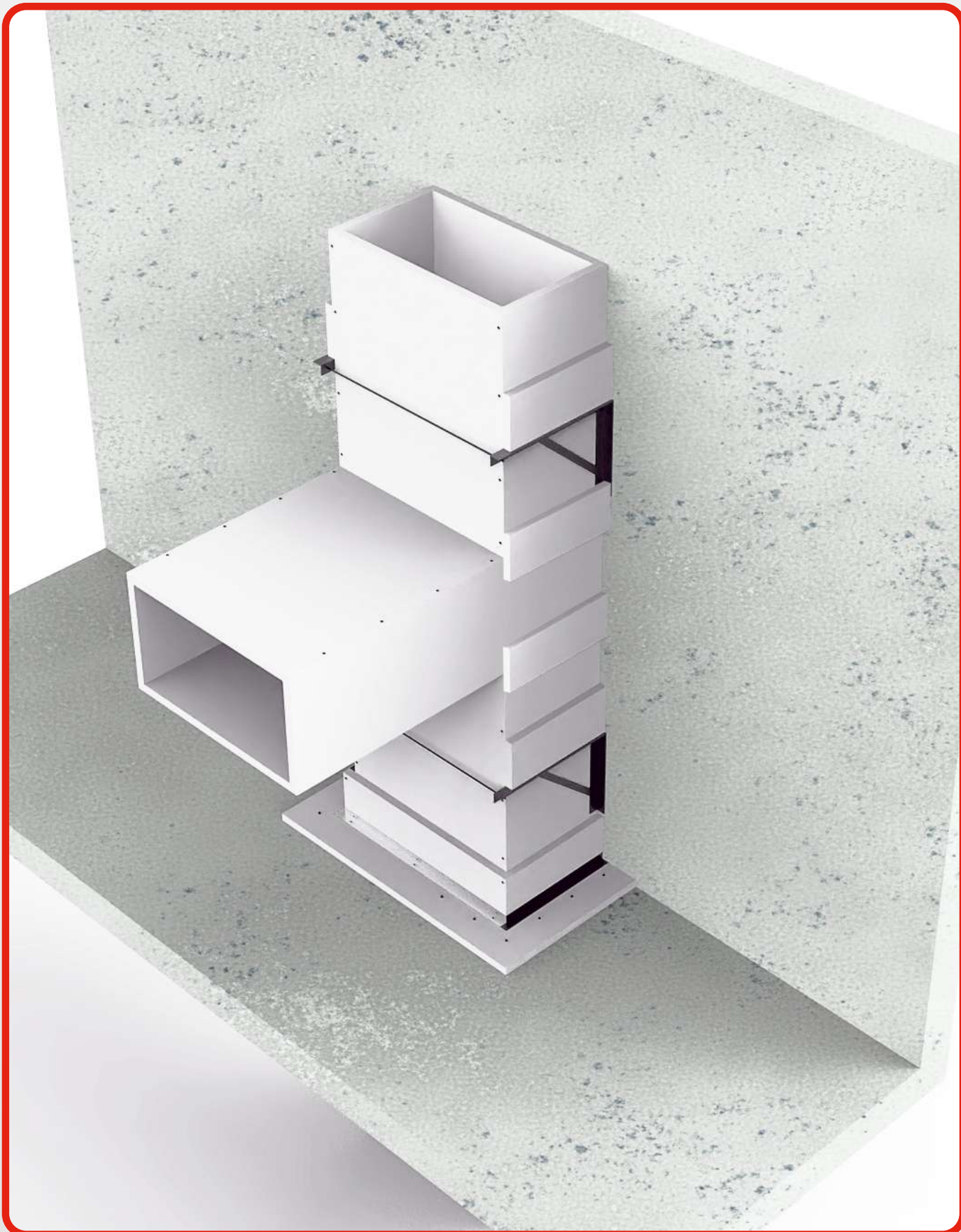
Anclaje vertical y empalme horizontal
