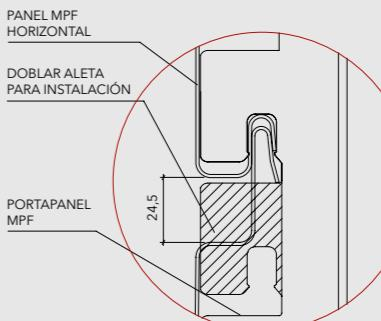
Nota: Si se endereza la aleta del portapanel después de la instalación, el panel no se puede desmontar.
