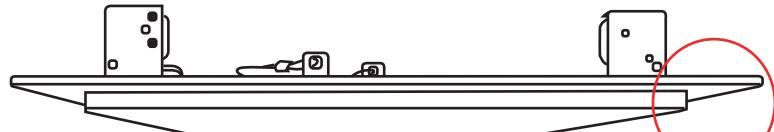
**NOTA:** Se recomienda respetar el espesor del cielo al momento de seleccionar la tapa, aristas de placas expuestas arriegan ingreso de humedad.
