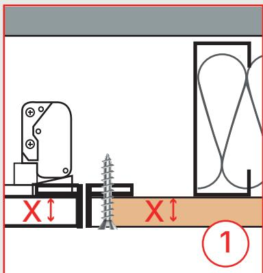
1. Utilizar tapa de inspección en el mismo espesor que la placa de cielo.
