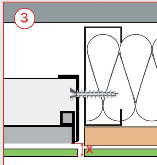
1. Ubicación de perfiles de refuerzo en sentido horizontal (entre montantes del tabique) en el perímetro del vano.(O al borde del vano).
