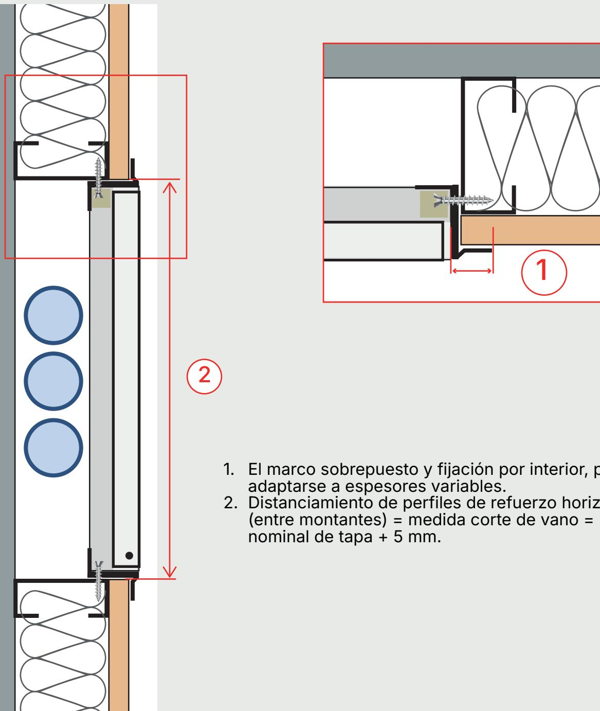
1. El marco sobrepuerto y fijación por interior, permite adaptarse a espesores variables.
