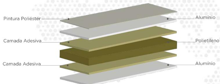
La combinación de la resistencia y durabilidad del aluminio con la maleabilidad del núcleo otorga al panel ACM EASYBOLD versatilidad para diferentes usos del segmento, tales como: revestimientos interiores, tabiques, tapas y acabados en la industria del mueble, revestimientos de carrocerías en la industria de carga y transporte y pequeñas fachadas en el segmento de comunicación visual.
