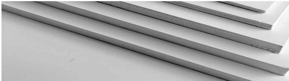
El PVC espumado, también conocido como PVC expandido consiste en planchas extruidas, fabricadas a partir de PVC expandido. Como resultado, se obtiene un producto ligero y resistente a impactos con gran homogeneidad. Una de sus ventajas es que tiene nula absorción a la humedad convirtiéndose en un material muy aislante.
